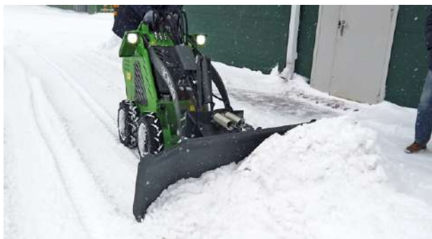
Уборка снега на территории предприятия (отвал плавающий отклоняющийся 1840)
