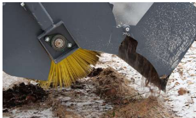
Очистка бункера от мусора
