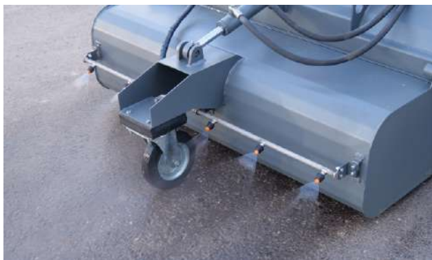
Щетка подметальная бункерная 1150 с системой орошения
