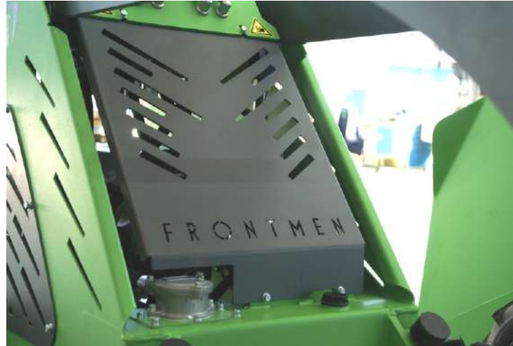
Передняя решетка (лазерная резка)
